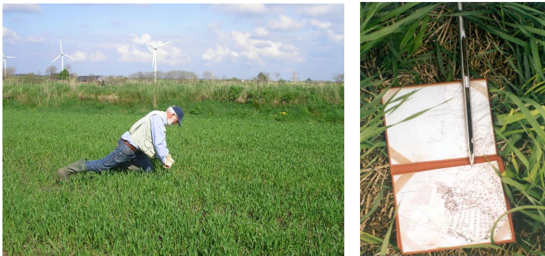
Figur 2. Det 1m lange karteringsspyd presses ned i jorden. Prøven sidder i en rille i spidsen. Jordarten bestemmes på stedet, og resultatet indtegnes på feltkortet.
